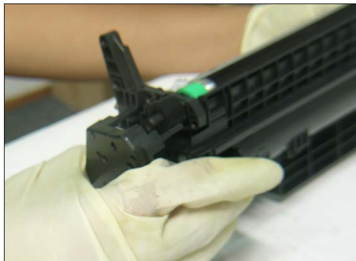
20. Saque la tapa ayudando al engranaje del rodillo magnético.
