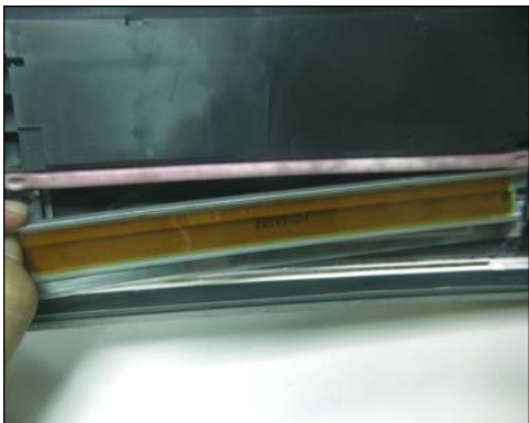
46. Posicionar la cuchilla de limpieza en su lugar y atornillarla.
