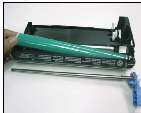
20. Cuidadosamente manipular el cilindro desde el extremo izquierdo hacia arriba y afuera del cartucho como se muestra. Si el cilindro OPC es reutilizable almacenarlo correctamente en lugar oscuro.
