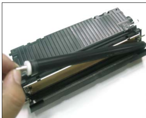
40. Montar el rodillo de revelación como se muestra.
