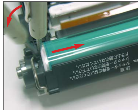
17. Con el desarmador insertado al costado izquierdo del cilindro hacer palanca con un pequeño giro para empujar el cilindro hacia la derecha. Esto también empujará el eje hacia afuera por el lado derecho.
