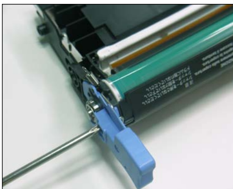
14. Con un desarmador phillips pequeño sacar los tornillos ubicados en las manijas azules. La manija de la izquierda sale fácilmente al sacar el tornillo.
