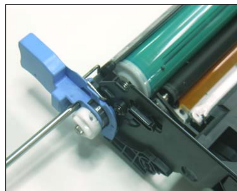
14. Con un desarmador phillips pequeño sacar los tornillos ubicados en las manijas azules. La manija de la izquierda sale fácilmente al sacar el tornillo.
