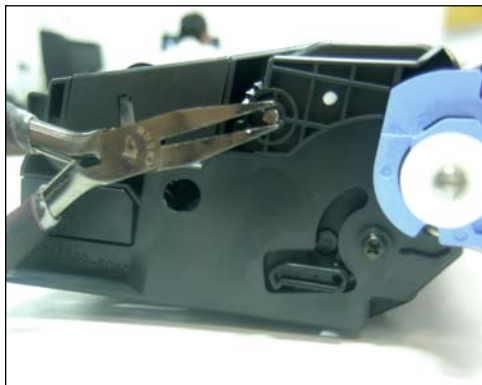
8. Asir la cabeza del perno con pinzas y extraerlo del cartucho.
