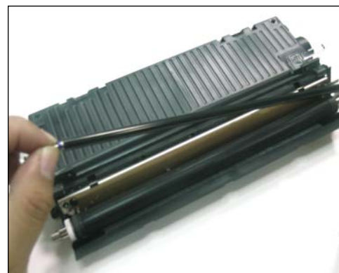
41. Montar luego el rodillo de carga de toner.
