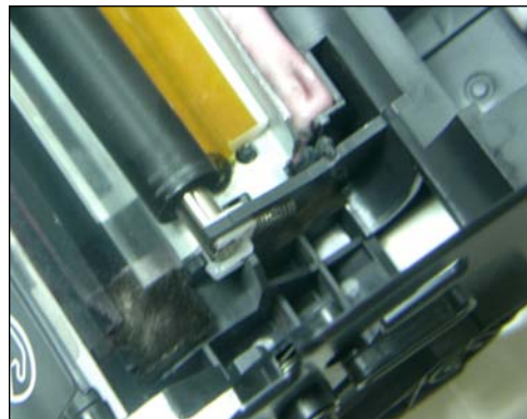
47. Montar el PCR en sus soportes como se muestra.
