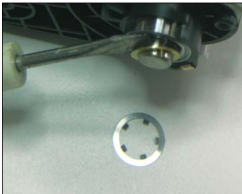
16. Luego retirar la arandela de la misma manera.
