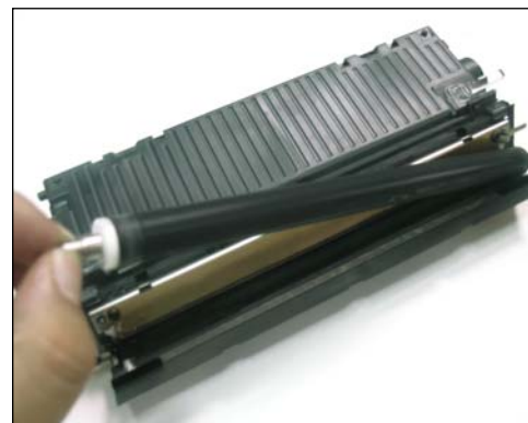
35. Luego retirar el rodillo de revelación de la misma manera. Cuidar de no extraviar los bujes blancos en cada extremo pues caen fácilmente del rodillo.
