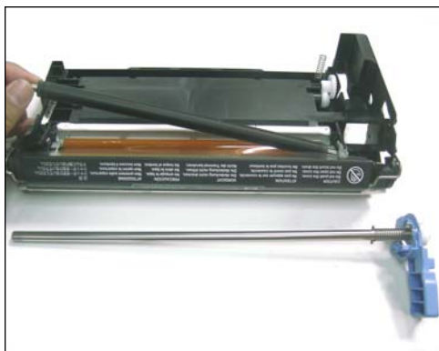
21. Sacar el PCR y limpiar con un paño humedecido con agua y jabón neutro. Permita esté perfectamente seco antes de montarlo nuevamente.
