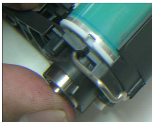
50. Sujetar el buje derecho en su lugar mientras se desliza el eje y posicionarlo hasta acoplar la chaveta de arrastre con la ranura del cilindro.
