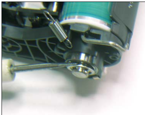
15. Sacar el clip estrella del eje del cilindro haciendo cuña con un desarmador plano pequeño.
