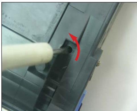
6. Insertar la punta del desarmador de 3mm con su plano perpendicular al perno y empujar la cabeza del perno hasta sacarlo.
