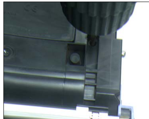
5. Efectuar un agujero de 4mm en dirección angular hacia el perno a través de cada ranura. La broca no deberá ir más profundo que la profundidad de los pernos.
