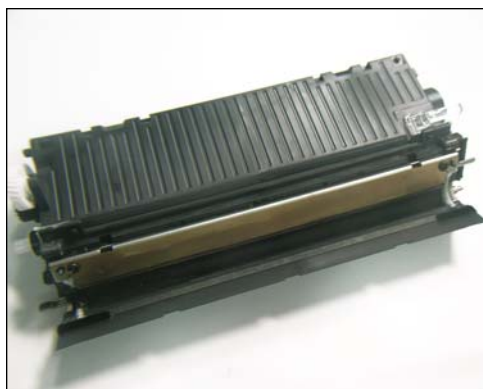
39. Colocar la cuchilla nuevamente en su lugar y fijar con sus dos tornillos.
