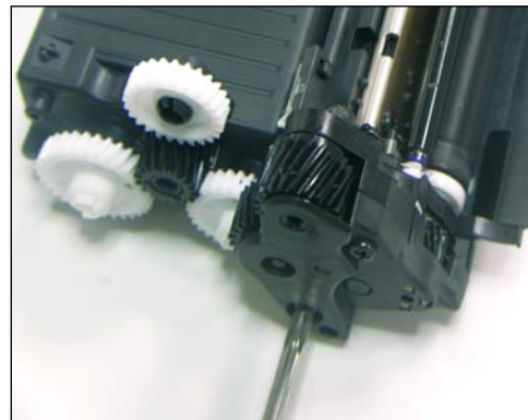
44. Montar la tapa lateral de los engranajes.
