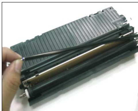
34. Primeramente sacar el rodillo de carga de toner tirando lateralmente.
