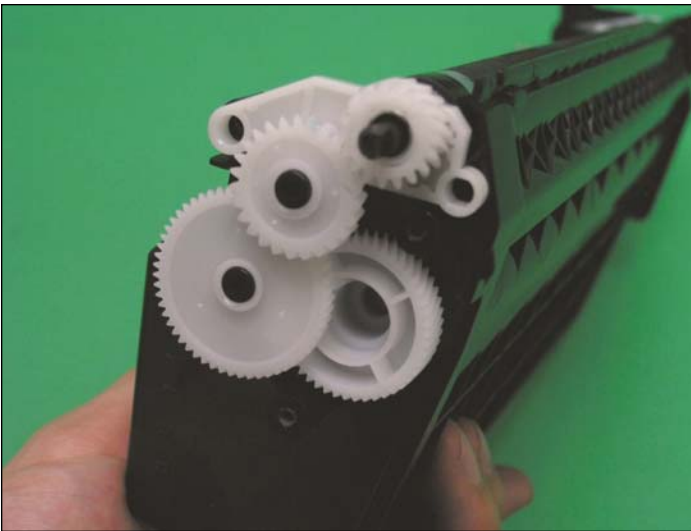
15. Instale el rodillo magnético en la cavidad como se muestra en la fotografía. Después inserte el estabilizador derecho, y todos los engranajes en la parte derecha de la cavidad.
