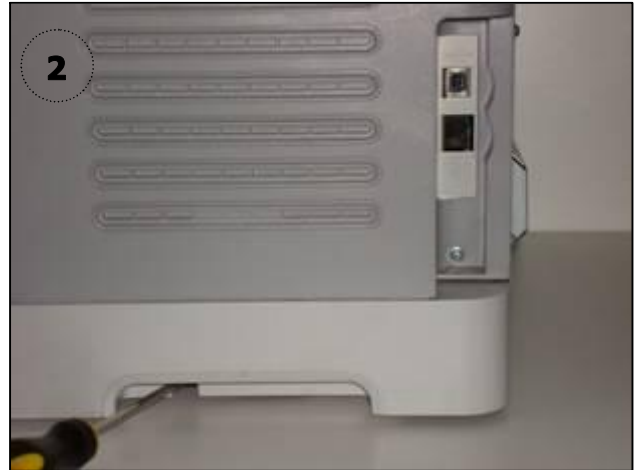
Sacar tornillo inferior del lateral derecho
