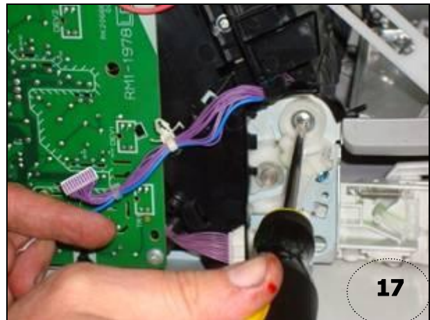
Destornillar la leva plástica
