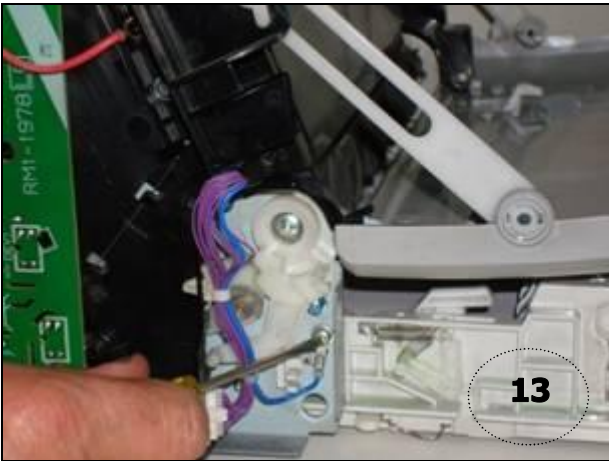
Desconectar el cable azul indicado
