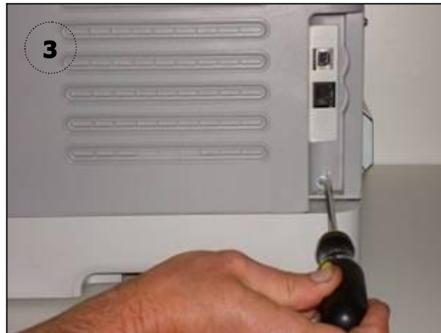
Sacar tornillo de la plaqueta de puertos
