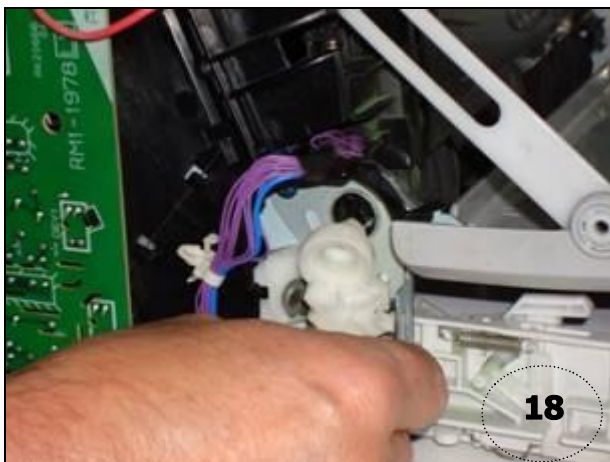
Retirar la leva con pinza de puntas o con la mano.
