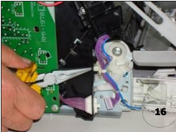
Empujar el soporte de los cables para sacarlo de la bisagra
